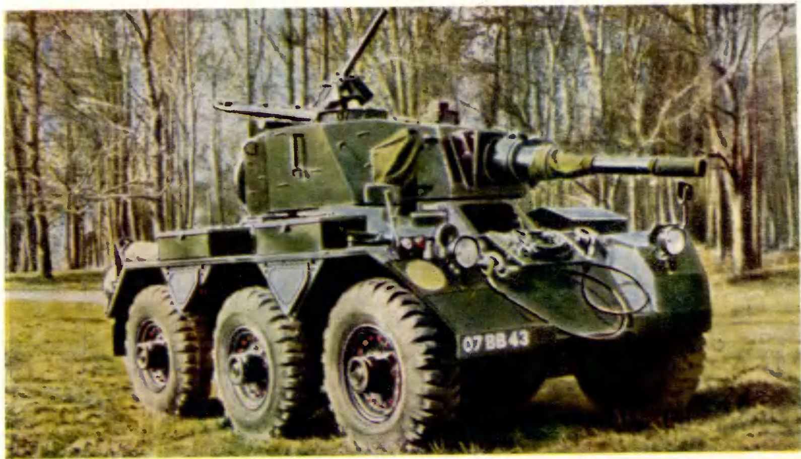
* Бронеавтомобиль F. V. 601C «Саладин» Mk2. Состоит на вооружении сухопутных войск Великобритании и многих стран Азии и Африки. Боевой вес машины 11,6 т, экипаж три человека (командир, механик-водитель и наводчик). Основное вооружение — 76,2-мм пушка (боекомплект 43 снаряда), дополнительное — два 7,62-мм пулемета (5000 патронов). Двигатель мощностью 170 л. с. обеспечивает движение с максимальной скоростью до 70 км/ч. Запас хода 400 км
