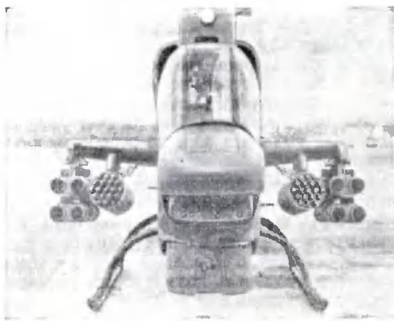
Рис. 1. Вариант размещения вооружения на американском вертолете огневой поддержки AH-1G «Кобра»
